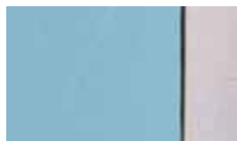
燁輝不銹鋼PVDF 烤漆鋼捲 (經過鹽霧試驗 3000 小時後) 邊緣處未有起泡腐蝕
