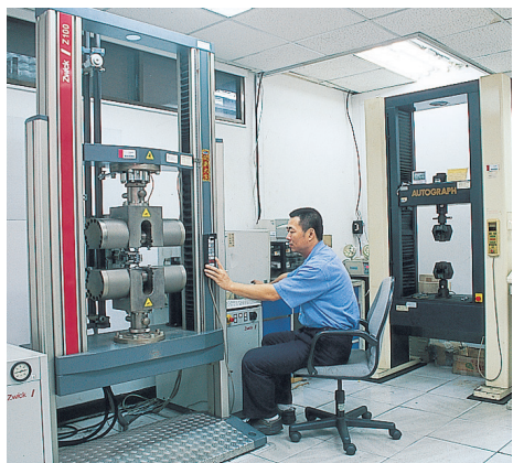
拉伸試驗機 Tensile Testing Machine
