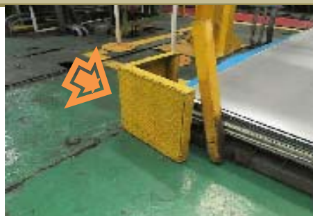
改善後：廢料區四周加設檔板，避免割傷傷害
